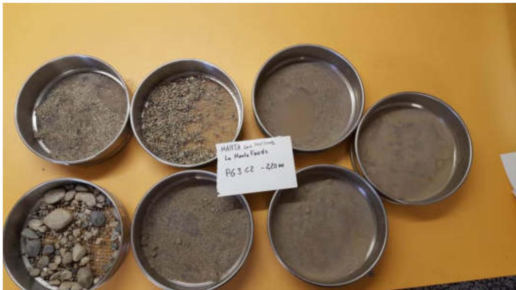
La ripresa documenta l'analisi di laboratorio (granulometria per setacciatura in via umida), eseguita sul campione estratto dal Pozzetto Geognostico (PG3 campione2).
